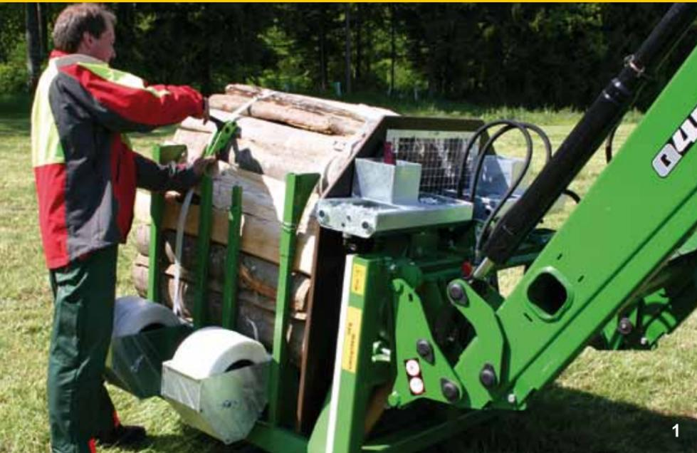
1 | Zwei Bandabroller bevorraten das Kompositband. Links und rechts sind Staufächer für Verschlussklemmen und Spanner vorhanden.
